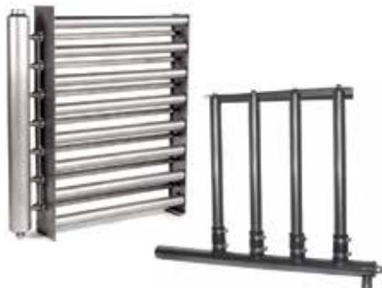
Armstrong **HumidiPack**® и **ExpressPack**® это предварительно собранный узел с разделителем/коллектором и несколькими парораспределительными трубками, предназначенный для уменьшения парового следа. Предназначен для установки в воздуховоды или воздухообрабатывающие агрегаты.
